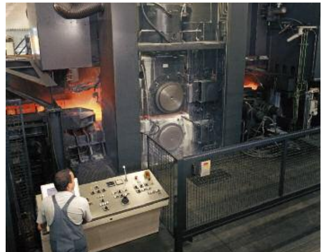
SMS group modernisierte umfassend die Warmwalzlinie der Wieland Werke AG in Deutschland. Herzstück ist das Duo-Reversierwarmwalzwerk.
