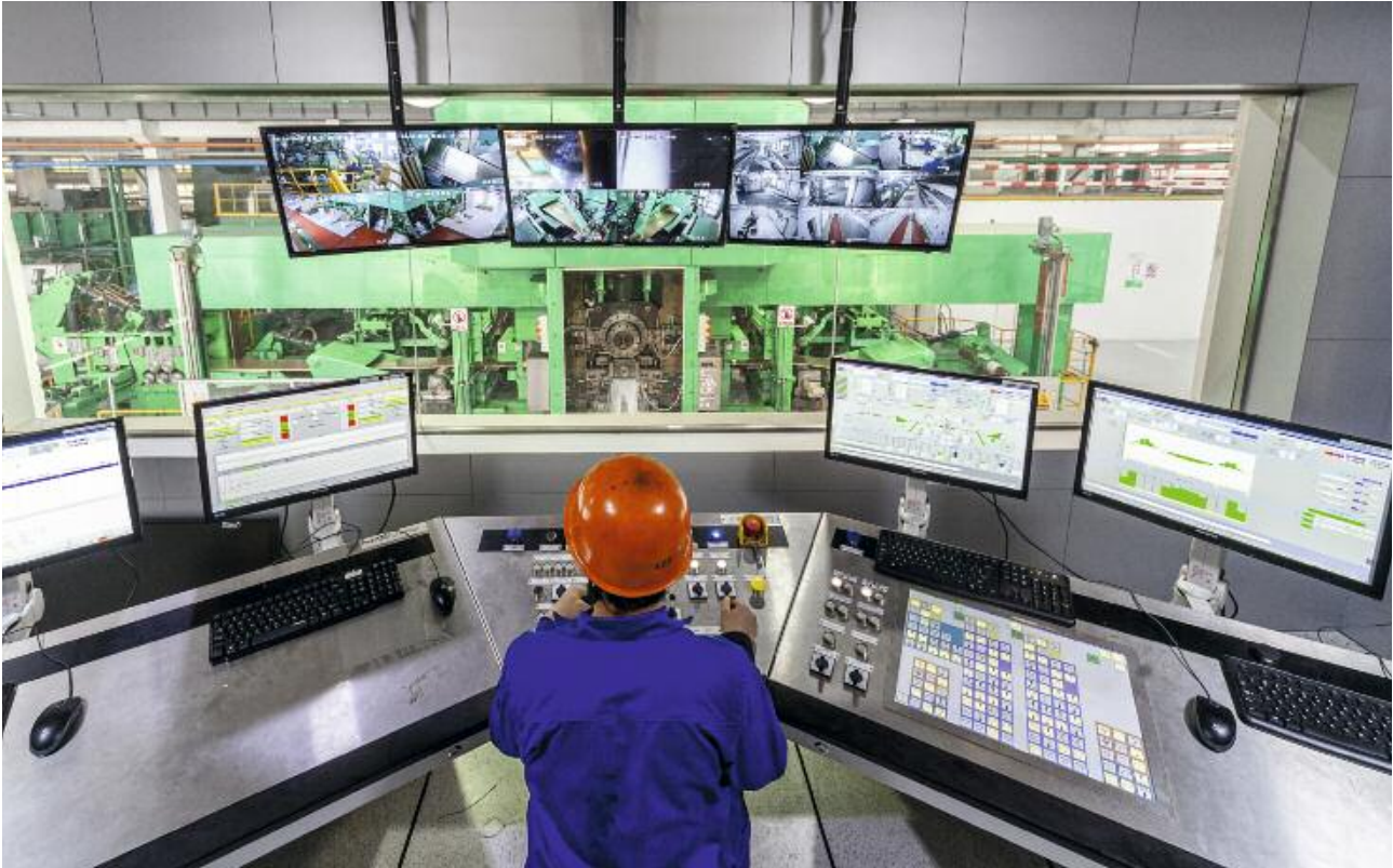
Im modernen Hauptsteuerstand laufen alle relevanten Informationen des vollautomatisierten Walzprozesses zusammen und werden visualisiert.
