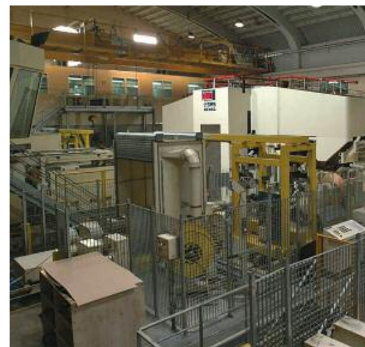
Die erste Kupferkaltwalzanlage von SMS mit einem System für dicken Arbeitswalzen und einer Level 2-Automation für hohe Ausbr
