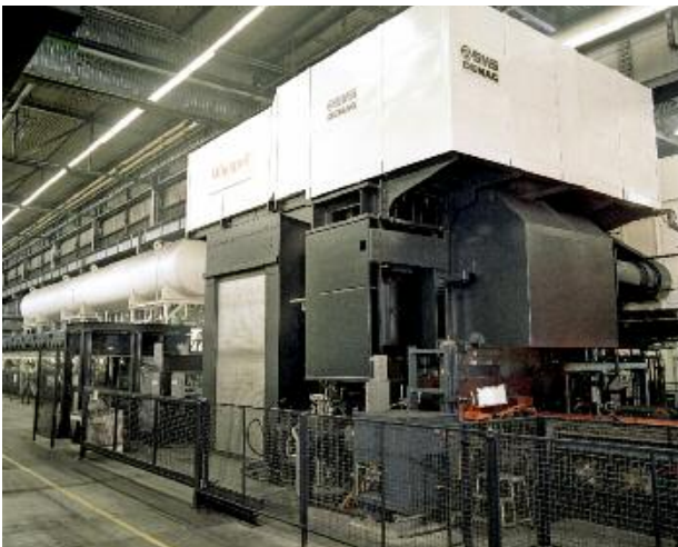
SMS group modernisierte umfassend die Warmwalzlinie der Wieland Werke AG in Deutschland. Herzstück ist das Duo-Reversierwarmwalzwerk.
