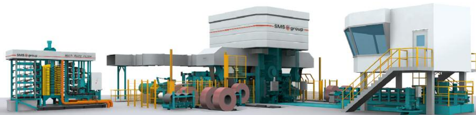
Aufbau einer Sexto Reversierkaltwalzanlage mit CVC®plus und Multi-Plate®-Filter für Kupferbänder.
