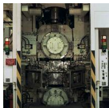
Die beiden Quarto-Walzgerüste bilden das technologische Herzstück der Tandemstraße.
