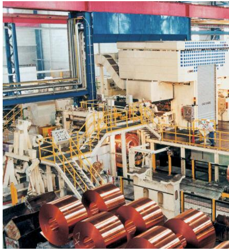
Die zweigerüstige Tandemstraße von MKM walzt ein großes Material- und Dickenspektrum.
