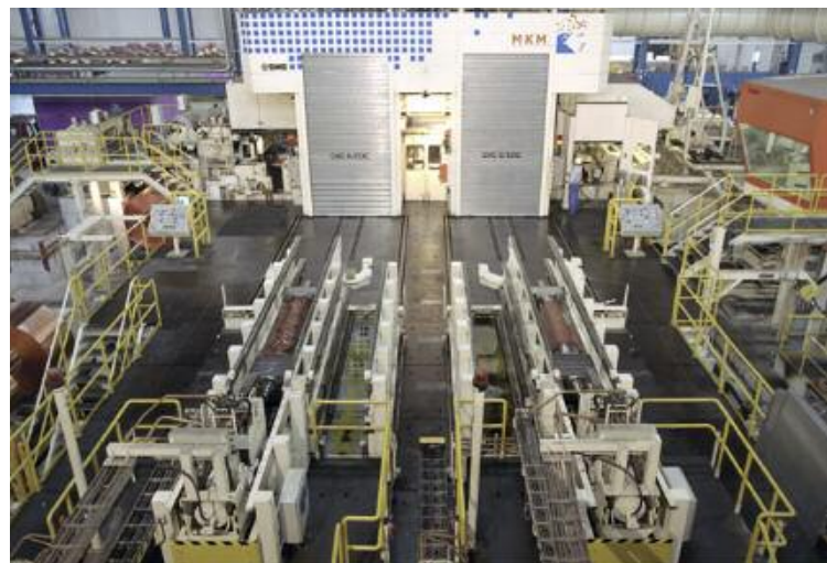
Die zweigerüstige Tandemstraße von MKM walzt ein großes Material- und Dickenspektrum.
