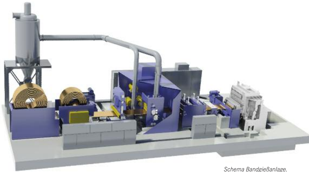
Schema Bandgießanlage.
