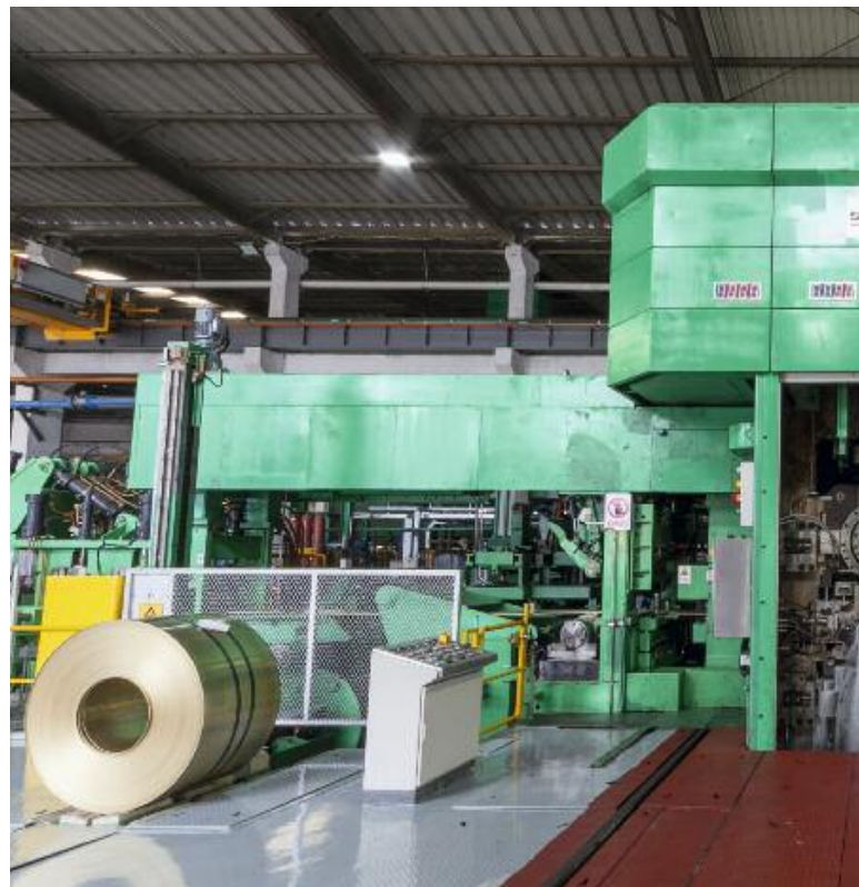
Die RCM in Vierwalzen-Bauweise mit einer Kombination aus Haspelrad und Haspeltrommel im Ein- und Auslauf.
